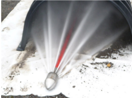
Bild 3: Spüldüse mit rückwärtigem Kegelstrahl
