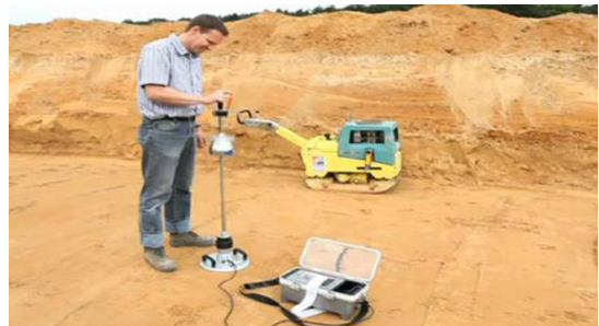
Bild 6: dyn. Plattendruckversuch im Planum
