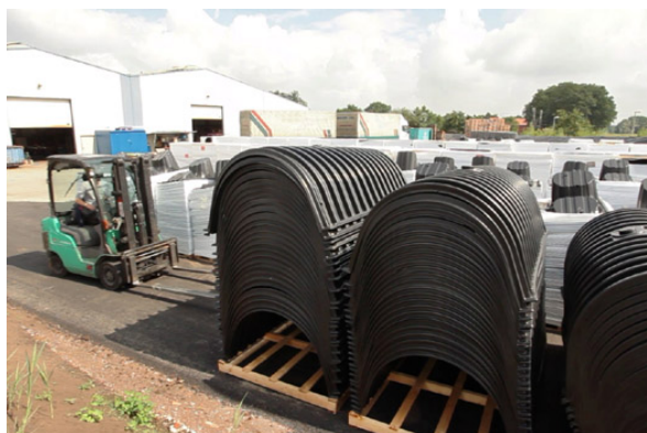
Bild 1: Palettentransport der Tunnelemente
