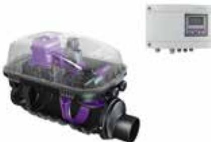
Rückstauerpumpenanlage mit einer Pumpe und einer Rückstauklappe. Einsatz der Pumpe für fäkalienfreies und fäkalienhaltiges Abwasser. Schalt- und Warngerät mit integriertem Selbstdiagnosesystem und Batteriepufferung. Motor überflutungssicher. Kabellänge 5 m.
