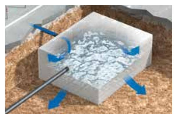
Effektive waterloc® Bauhöhe H=250mm pro Lage
