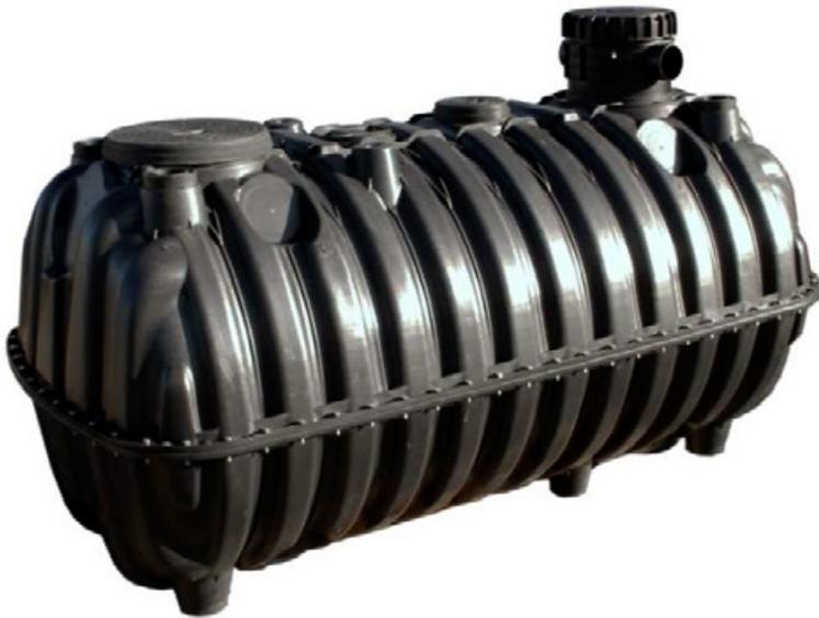
Dieser robuste, zweischalige Regenwassertank besteht aus umweltfreundlichem, recycelbarem Polypropylen Kunststoff. Der Tank verfügt über drei Schachtöffnungen in DN200, DN300 und DN400. Nicht benötigte Öffnungen werden mit den im Lieferumfang enthaltenen Kappen verschlossen. Zudem verfügt der Tank über seitliche Anschlussflächen für Rohranschlüsse in DN100 mm. Umfangreiches Zubehör ermöglicht eine Vielzahl von Ausstattungsvarianten.
