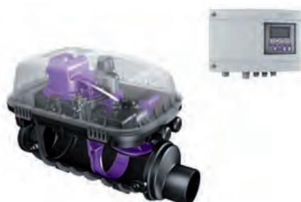
Rückstaupumpenanlage mit einer Pumpe und einer Rückstauklappe. Einsatz der Pumpe für fäkalienfreies und fäkalienhaltiges Abwasser. Schalt- und Warngerät mit integriertem Selbstdiagnosesystem und Batteriepufferung. Motor überflutungssicher. Kabellänge 5 m.
