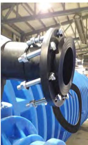
Vorschweißbund sowie Losflansch zur bauseitigen Montage der Be- und Entlüftung sowie der Löschwasser Entnahmestelle.
