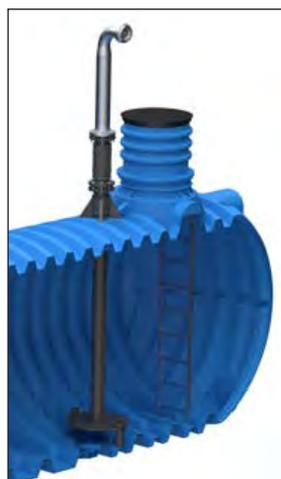
PE-HD Saugrohr DA125, 100 mm vor Tanksohle endend 45° abgeschrägt, sowie Antiwirbelplatte zum störungsfreiem Ansaugen von Löschwasser. Werkseits montiert. Einsteigleiter von Tanksohle bis Tankscheitel.
