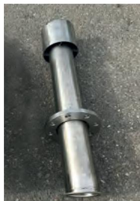
Be- und Entlüftungsrohr DN100 aus Edelstahl 1.4301 mit Dunsthaube, Flansch, Dichtplatte sowie Edelstahlverschraubungen. Bauseitige Montage.
