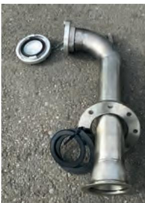
Löschwasser Entnahmestelle DN125/100 mit Storz A-Kupplung aus Edelstahl 1.4301 mit Flansch, Dichtplatte sowie Edelstahlverschraubungen. Bauseitige Montage.
