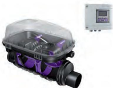
Die Rückstauklappe schließt bei Rückstau vollautomatisch. Die 2. Klappe dient als handverriegelbarer Notverschluss und als Einfachrückstauverschluss. Schalt- und Warngerät mit integriertem Selbstdiagnosesystem und Batteriepufferung. Motor überflutungssicher. Kabellänge 5 m.
