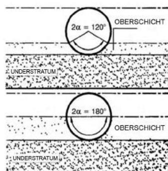
Die Bettung muss in voller Länge gleichmäßig ausgeführt werden, sodass die Rohre nicht nur an einigen Stellen aufliegen, und im Bereich der Muffenverbindung muss eine kleine Vertiefung gemacht werden, damit sie nicht auf der verdichteten Grundlage aufliegt und keine punktuelle Belastung entsteht.
